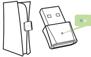
**ÉTAPE 1:** Coupler le DG80P : Insérez le DG80P dans le port USB de la PS5. La LED du DG80P clignotera en bleu et blanc. Si ce n'est pas le cas, appuyez et maintenez le bouton du DG80P pendant 2 secondes jusqu'à ce qu'elle clignote en bleu et blanc.
