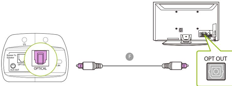
**NOTE:** La plupart des TV prennent en charge la sortie audio via un seul port numérique à la fois. Donc si le port HDMI ARC de votre TV est utilisé, le port optique peut être désactivé. Vous pouvez débrancher l'HDMI ARC ou essayer de connecter l'émetteur via RCA/AUX.
