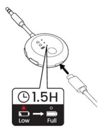
Una luz roja fija en el transmisor indica que la carga está en progreso; el LED se apagará para indicar una carga completa.
