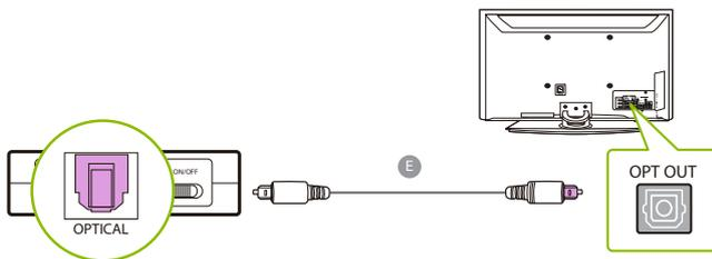
*NOTE: La plupart des TV ne transmettent l'audio que sur 1 port de sortie numérique à la fois. Si l' HDMI ARC est utilisé, le port optique peut être désactivé. Débranchez l' HDMI ARC ou essayez de connecter l'émetteur via*
