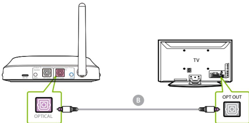
**NOTA:** La mayoría de los televisores admiten salida de audio a través de un solo puerto de salida digital a la vez, por lo que si el puerto HDMI ARC del televisor está en uso, es posible que el puerto óptico esté desactivado. Puede desconectar el dispositivo HDMI ARC o intentar conectar el transmisor a través de RCA/AUX.
