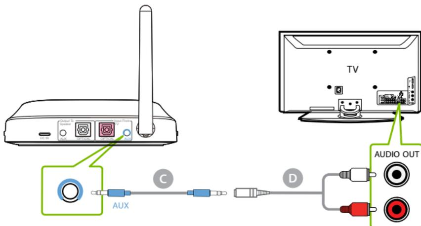
**NOTA:** Verifique dos veces para asegurarse de que los cables ópticos/RCA estén conectados a los puertos de SALIDA de audio del televisor y no a los puertos de ENTRADA DE AUDIO/ENTRADA DE COMPONENTES.
