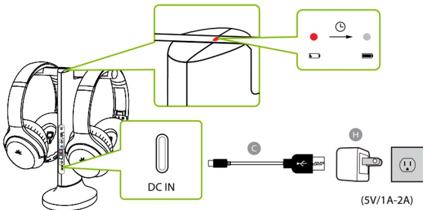
È inoltre possibile caricare le cuffie tramite le loro porte di alimentazione utilizzando il cavo di ricarica USB C (Figura D) e un adattatore USB. Una luce rossa fissa indica che la ricarica è in corso; Una volta spenta la luce, le cuffie saranno a batteria piena.
