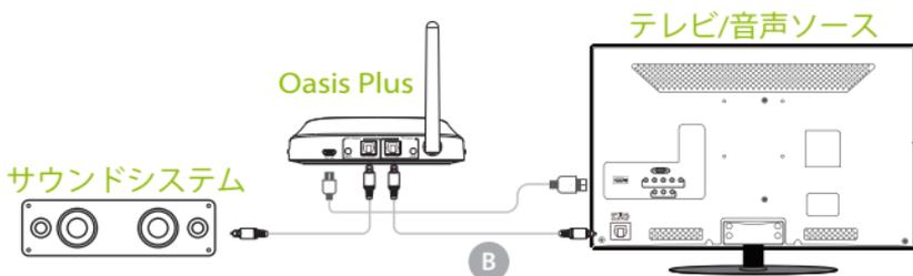
注意: バイパスは同じタイプの入力/出力でのみ機能します。つまり、出力でテレビに接続する場合、出力でスピーカーに接続する必要があります。
