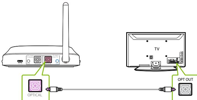
**NOTE:** La plupart des TV prennent en charge la sortie audio via un seul port de sortie numérique à la fois. Mais si le port HDMI ARC de votre TV est utilisé, le port optique peut être désactivé. Tentez de débrancher l'appareil HDMI ARC, ou de connecter l'émetteur via RCA/AUX.
