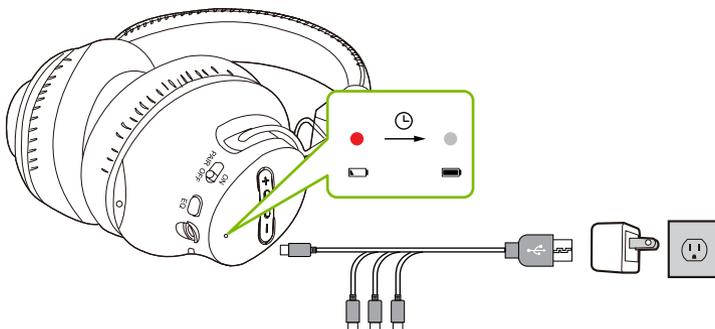
*NOTE: Nous vous recommandons d'utiliser un adaptateur USB de 1A-2A de puissance pour charger vos écouteurs, en particulier lorsque vous rechargez 4 écouteurs simultanément. La charge avec un adaptateur de 500 mA peut entraîner des temps de recharge plus longs avec plusieurs écouteurs branchés en même temps.*
