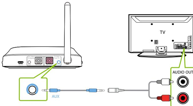
*Note: Vérifiez à nouveau que les câbles optiques / RCA soient branchés sur les ports de sortie audio du téléviseur et non sur les ports AUDIO IN / COMPONENT IN.*
