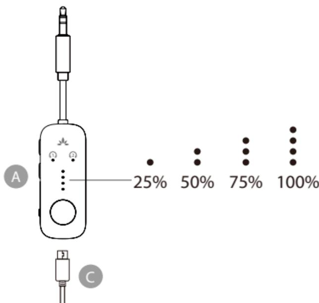
付属のUSB-C充電ケーブルを充電ポートに差し込み、もう一方の端を5V/500mA-2A規格のUSBアダプター（お使いの携帯電話の充電器などで問題ありません）またはPCのUSBポートに接続します。
